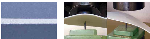
踏抜き性能試験
